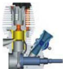
Поршень в нижней мертвой точке (ВМТ)
