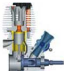
Поршень в верхней мертвой точке (ВМТ)
